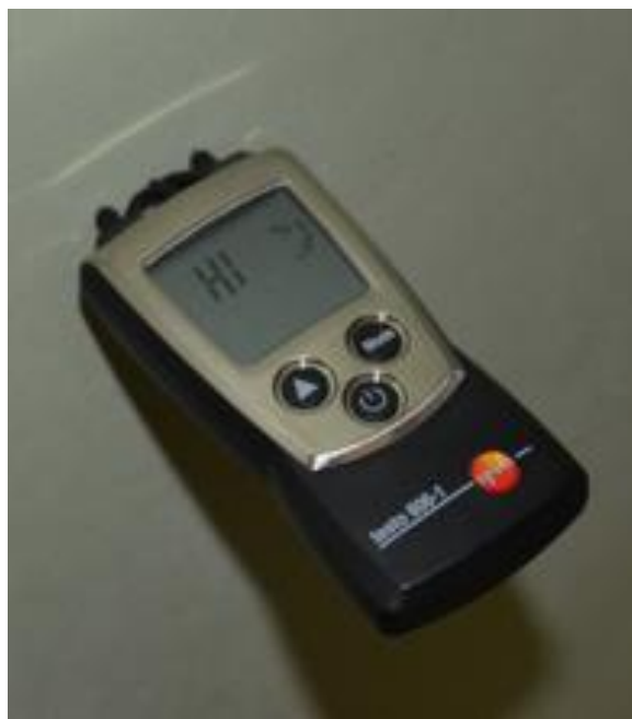
Fot. 14. Pomiar wilgotności ściany w pomieszczeniu magazynowym w dolnej części tj. w obrębie zacieku. Wynik poza skalą wilgotnościomierza – ściana mokra [1.6].
