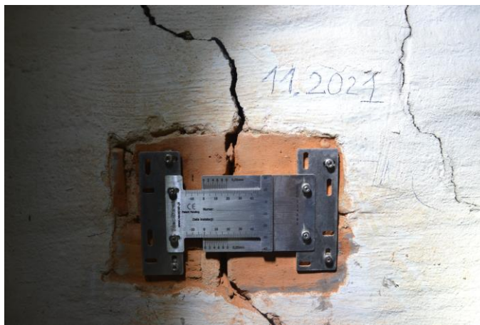
Fot. 20. Rysomierz zamontowany na ścianie naprzeciw schodów. Wynik rozwarcia 0 mm [1.6].
